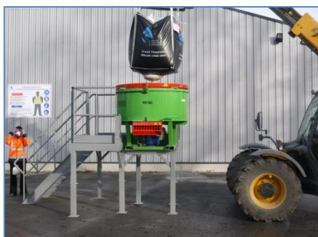
MINI-CENTRALE À BÉTON
