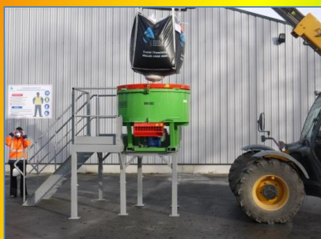
MINI-CENTRALE À BÉTON
