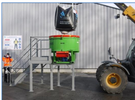
MINI-CENTRALE À BÉTON
