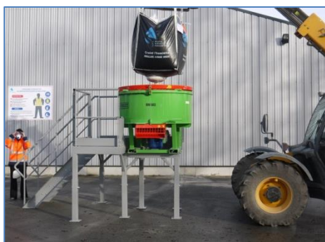
MINI-CENTRALE À BÉTON
