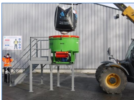
MINI-CENTRALE À BÉTON
