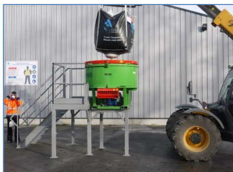
MINI-CENTRALE À BÉTON
