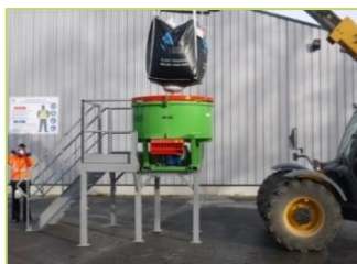
MINI-CENTRALE À BÉTON
