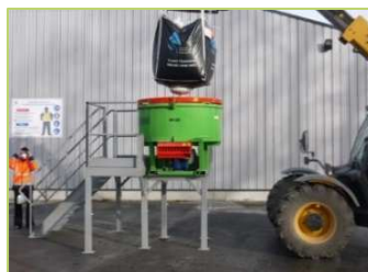
MINI-CENTRALE À BÉTON
