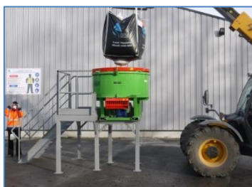
MINI-CENTRALE À BÉTON
