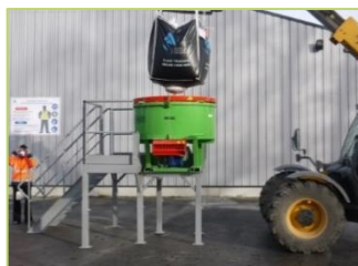
MINI-CENTRALE À BÉTON
