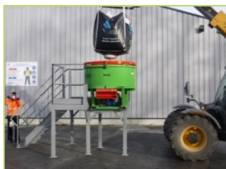
MINI-CENTRALE À BÉTON
