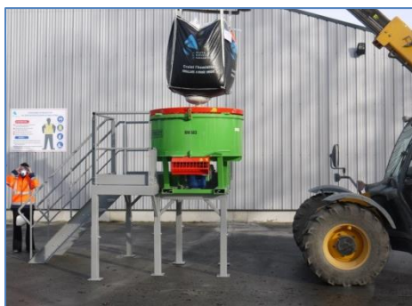
MINI-CENTRALE À BÉTON
