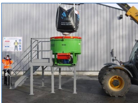
MINI-CENTRALE À BÉTON
