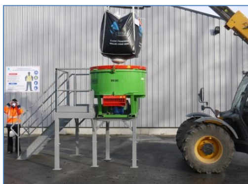
MINI-CENTRALE À BÉTON
