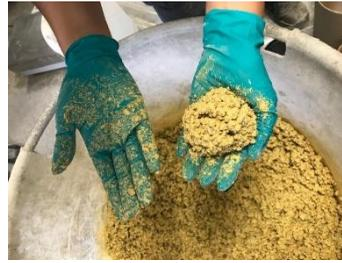
Mortier correct : la boulette se tient, un peu de laitance résiduelle sur le gant opposé
