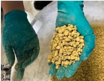
Le mortier n'est pas suffisamment hydraté : la boulette ne se tient pas, et pas de laitance résiduelle sur le gant opposé
